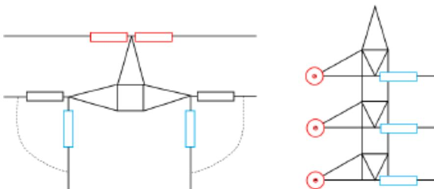
**Figura 11** – Esquema de contorno de circuito duplo
