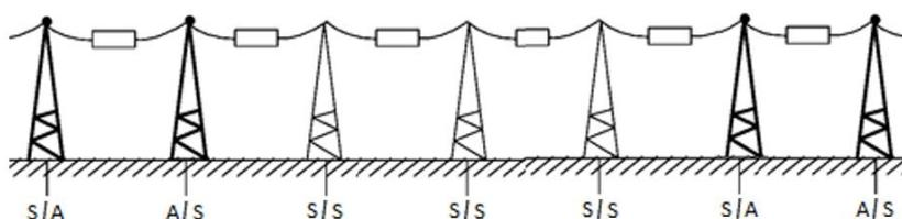
**Figura 03** – Série de Circuito Duplo – Tensão de ancoragem (A) e suspensão (S)
